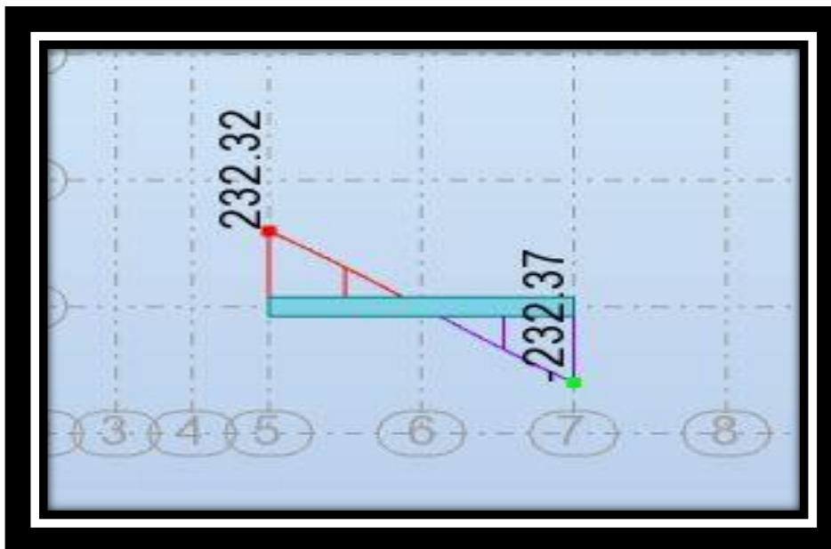
مخطط قوى القص ( Shear Forces Diagram )
